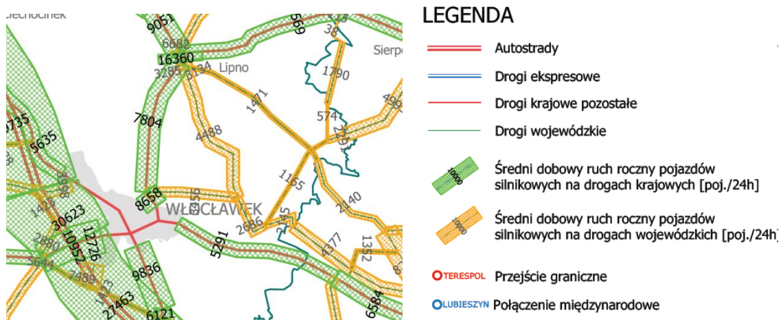
Rysunek 21. Mapa średniego dobowego ruchu rocznego pojazdów silnikowych na drogach krajowych i wojewódzkich, GPR 2020/21
