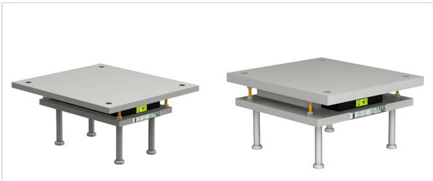
Łożysko elastomerowe wielokierunkowo przesuwne Typ 1.1 wraz z konstrukcją podtrzymującą. Górna płyta łożyska przystosowana do kotwienia w konstrukcji stalowej obiektu mostowego.
