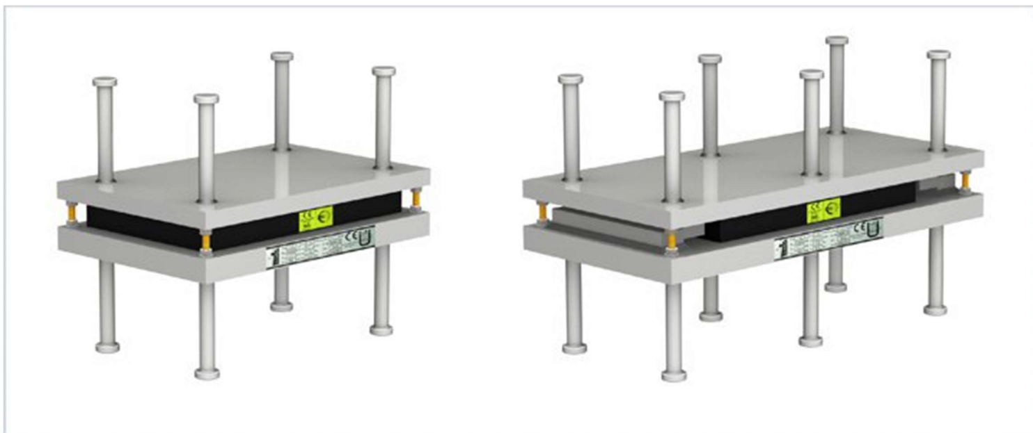
Łożysko elastomerowe wielokierunkowo przesuwne Typ 1.1 wraz z konstrukcją podtrzymującą obustronnie kotwioną w betonie.
