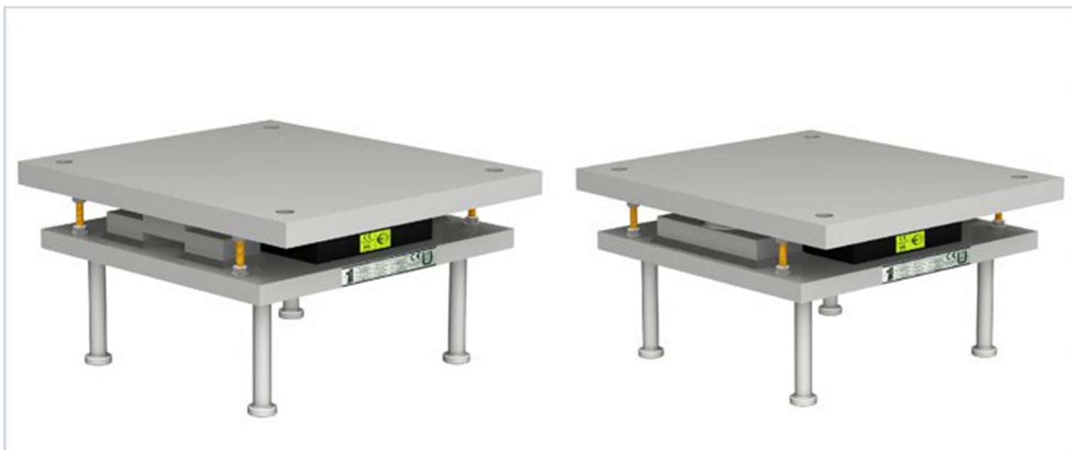
Łożysko elastomerowe wielokierunkowo przesuwne Typ 1.1 wraz z konstrukcją podtrzymującą. Górna płyta łożyska przystosowana do kotwienia w konstrukcji stalowej obiektu mostowego.
