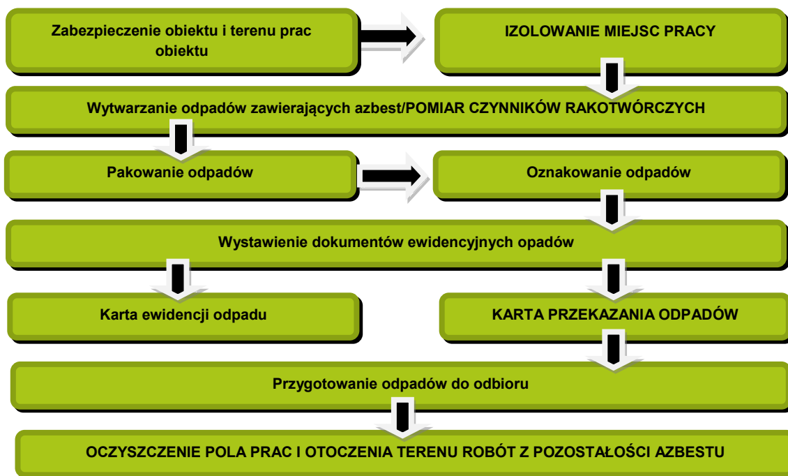
Rysunek 9. Schemat procedury dotyczącej prac polegających na usuwaniu wyrobów zawierających azbest, wytwarzania odpadów niebezpiecznych wraz z oczyszczaniem obiektu/terenu/instalacji.
